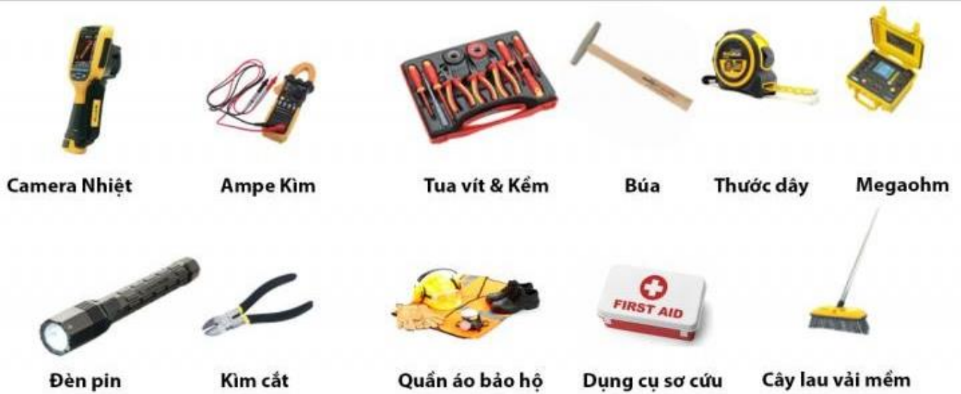
Hình 8. Các công cụ cần thiết cho kiểm tra hệ thống điện
