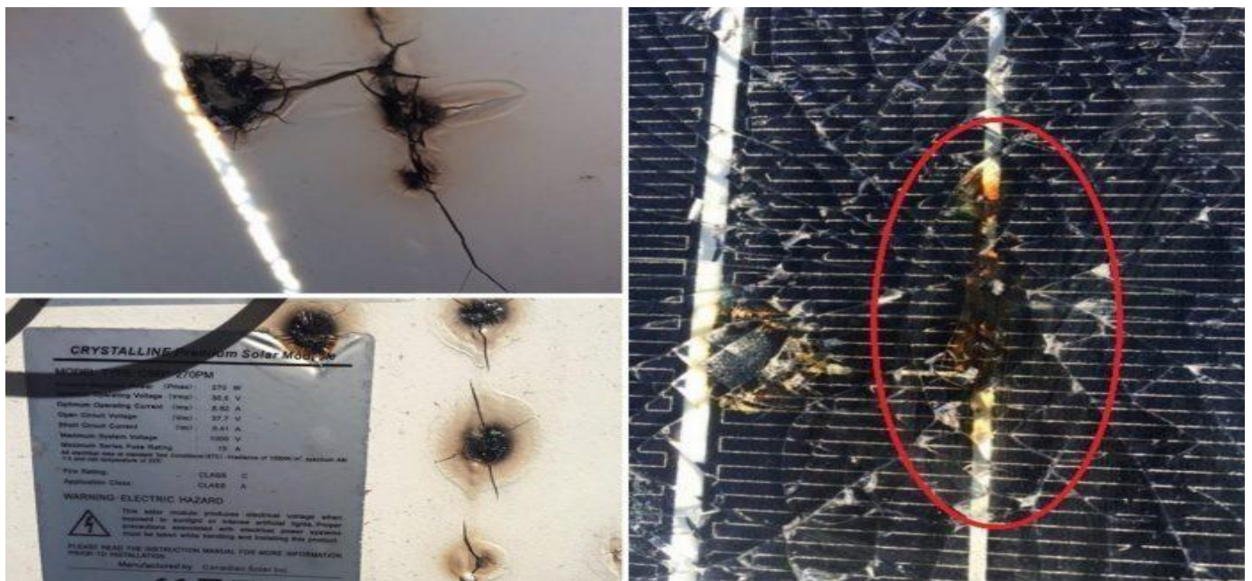
Hình 7. Bụi bẩn ,vật thể lạ trên bề mặt gây hiện tượng hotspot cho tấm pin
